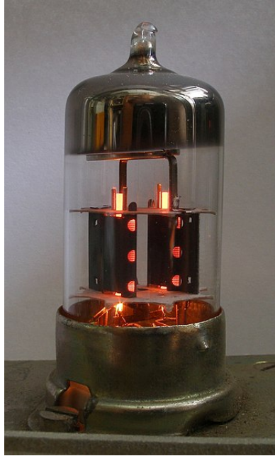
Figura 24: Esempio di valvola in funzione
