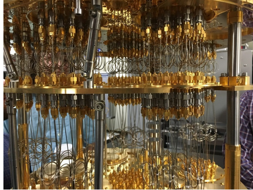
Figura 30: il core di un computer quantistico
